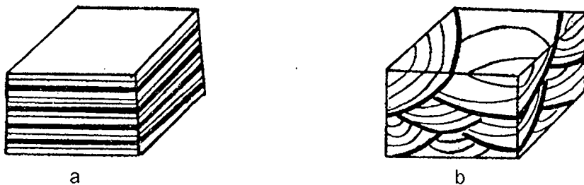
Hình 3.4. Sơ đồ khối các kiểu phân lớp. a) Phân lớp nằm ngang; b) Phân lớp sóng xiên.
